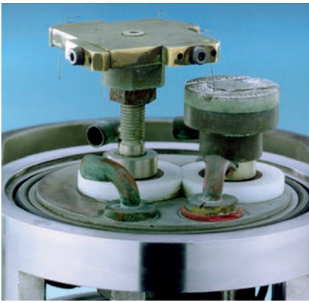
BILD 2 Kontaktanordnung des Funkenprüfgerätes nach IEC 60079-11
